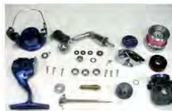
Ο μηχανισμός αποσυναρμολογήθηκε, καθαρίστηκε και ελέγχθηκαν τα εξαρτήματα για φθορές
