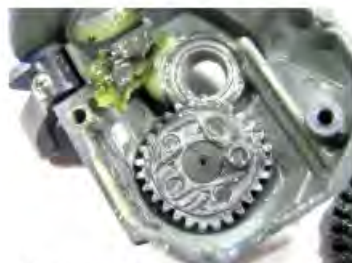
Το γρανάζι τάλαντωσης με ελάχιστα κουρασμένα λιπαντικά
