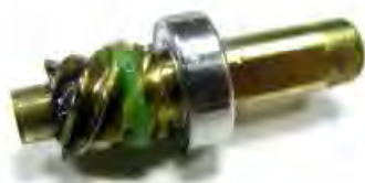
Στο pinion gear στο σημείο επαφής ελάχιστα μαύρα λιπαντικά.
