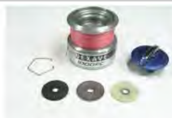
Η κοιλότητα των φρένων καθαρίστηκε και τοποθετήθηκε ροδέλα Carbondex
