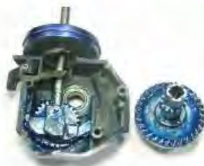
Ο μηχανισμός στο στάδιο της συναρμολόγησης με νέα λιπαντικά
